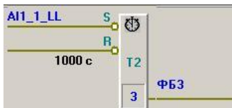
Тип 3 «Короткий импульс»
