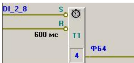
Тип 2 - «Задержка отключения»
